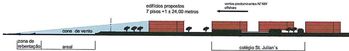
Fig.19. Impacte dos edifícios projetados na aerodinâmica da Praia de Carcavelos para vento "offshore" de quadrante nordeste. Representamos o cone de sombra onde ocorrerão turbulências.
