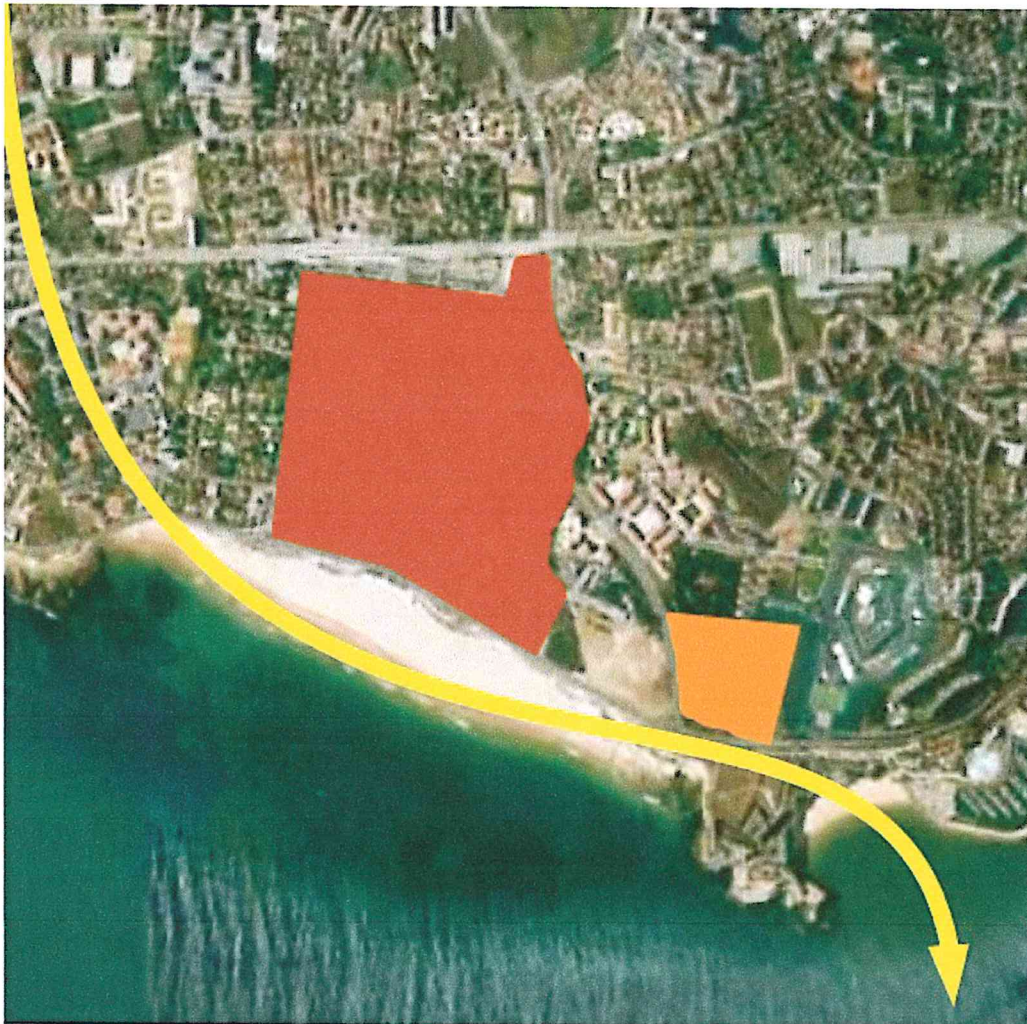
Fig.20. Impacte dos edifícios projetados na aerodinâmica da Praia de Carcavelos para vento "offshore" de quadrante noroeste. Representamos a rotação do escoamento, que passa de "sideshore" sobre a praia, afetando de forma muito negativa o surf bem como contribuindo para acelerar a erosão da praia influenciando na deriva litoral.
