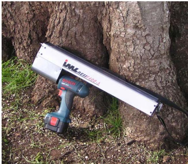
**Figura 1 – Análise instrumental com recurso a resistógrafo F 400-S.**
