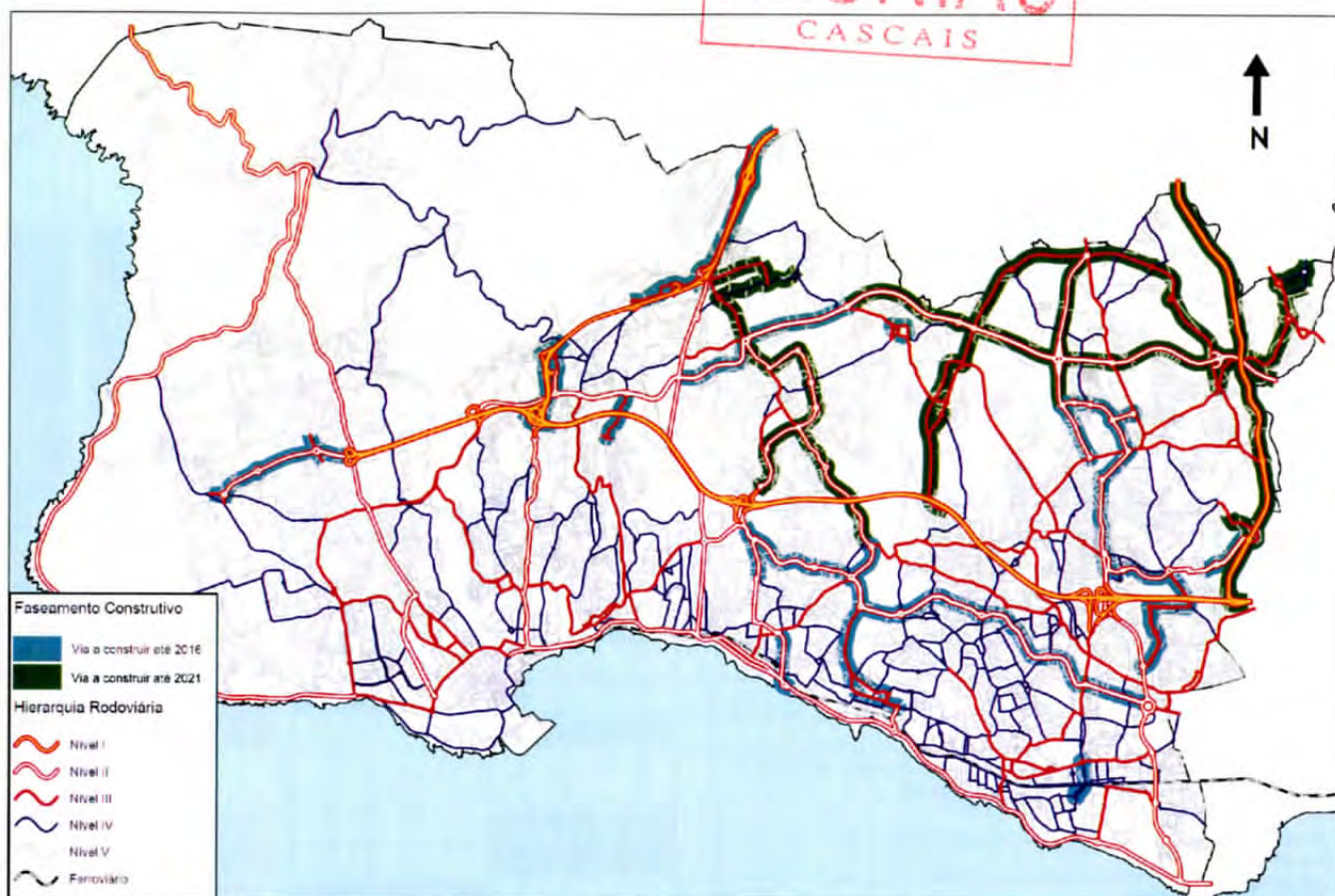
Figura 16 – Proposta de faseamento da construção das novas vias rodoviárias
