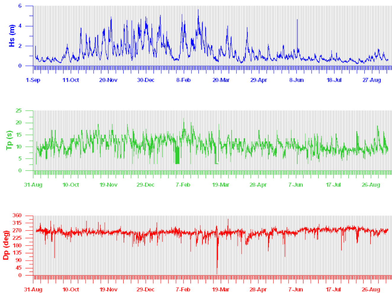
Figura A – 1 – Observações da Altura Significativa (gráfico a azul), Período de Pico (gráfico a verde) e Direcção de Pico (gráfico a vermelho) obtidas na estação ERHL para o período entre 3 de Setembro de 2009 e 13 de Setembro de 2010.
