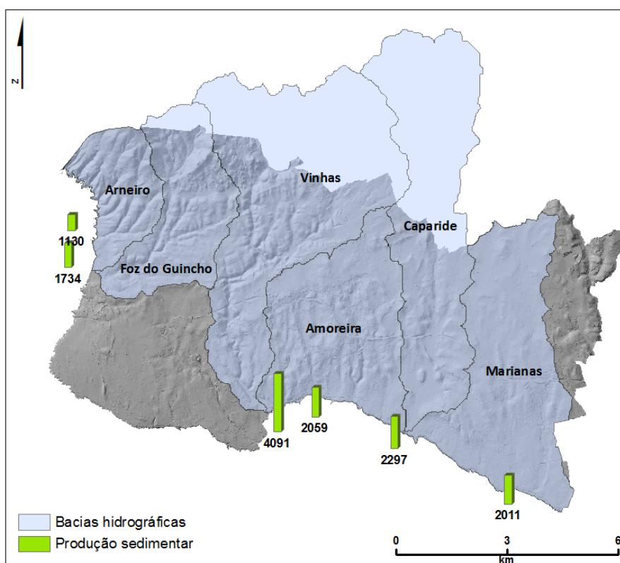
Figura 19 – Representação das bacias hidrográficas que drenam para o litoral do concelho de Cascais e descarga sólida relativa à fracção arenosa ( $\text{m}^3/\text{ano}$ ).
