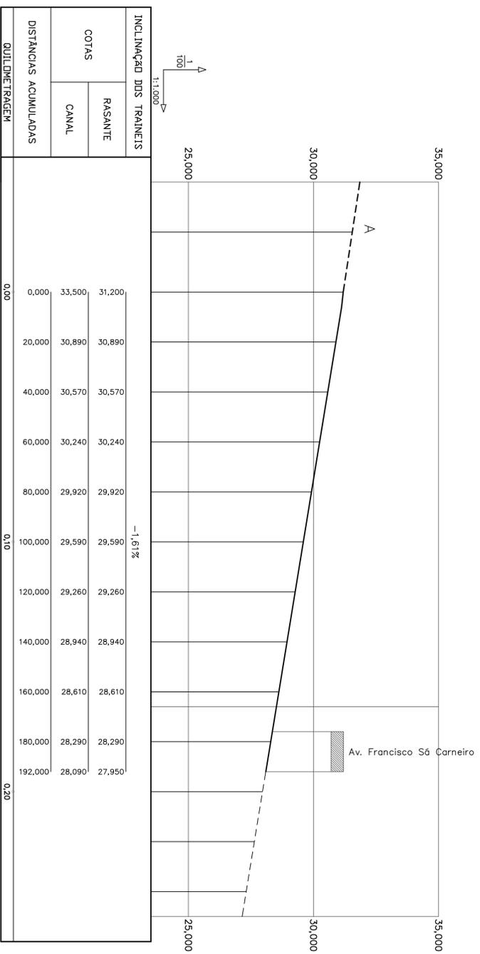
A – Inclinação do canal objecto do Projecto de Valorização e Reabilitação da Ribeira de Sassoeiros entre A5 e Aldeamento das Encostas.
