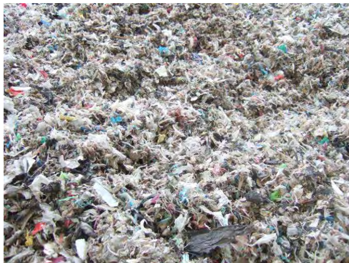
Figura nº 220 Combustível Derivado de Resíduos (CDR) obtido a partir de refugos da CITRS de Trajouce
