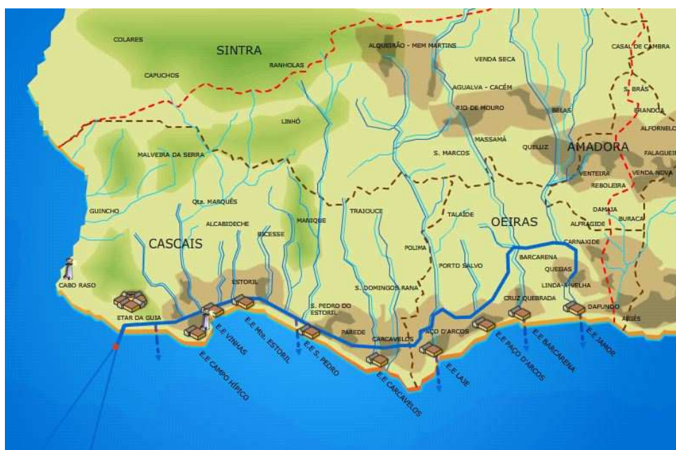
Figura nº 211 Intercetor geral e estações elevatórias
