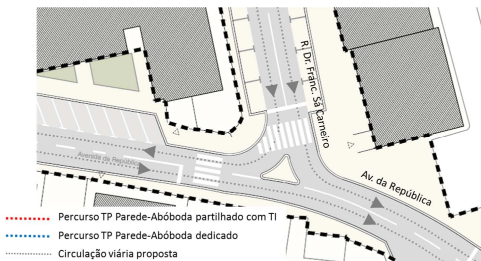
Figura 39 | Esquema de circulação proposto na interseção Av. da República / R. Dr. Francisco Sá Carneiro Fonte: Base CMC com tratamento Mobilidade Suave
