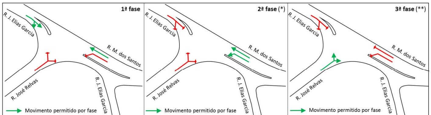
Figura 33 | Esquema de semaforização proposto na interseção R. José Elias Garcia / R. José Relvas / R. Machado dos Santos
