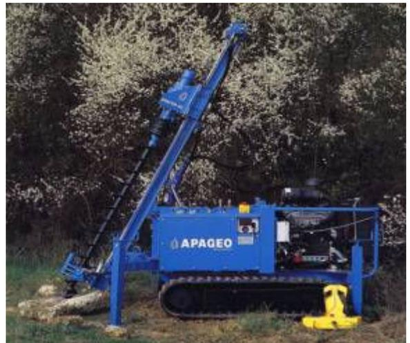
Para o avanço da furação recorreu-se a trados helicoidais de comprimento de 1,50 m de diâmetro 110 mm
