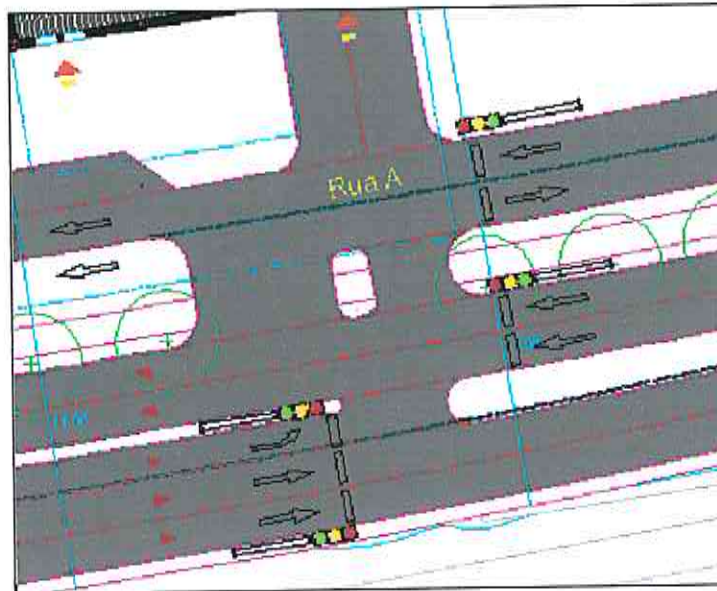
Figura 11 – Configuração do Cruzamento Semaforizado entre a Av. Marginal e a Via de Serviço
