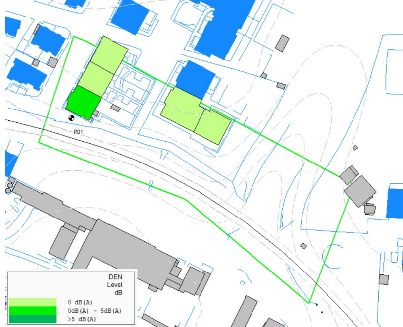
Figura 4 – Condições de fachada do Edifício - Ln
