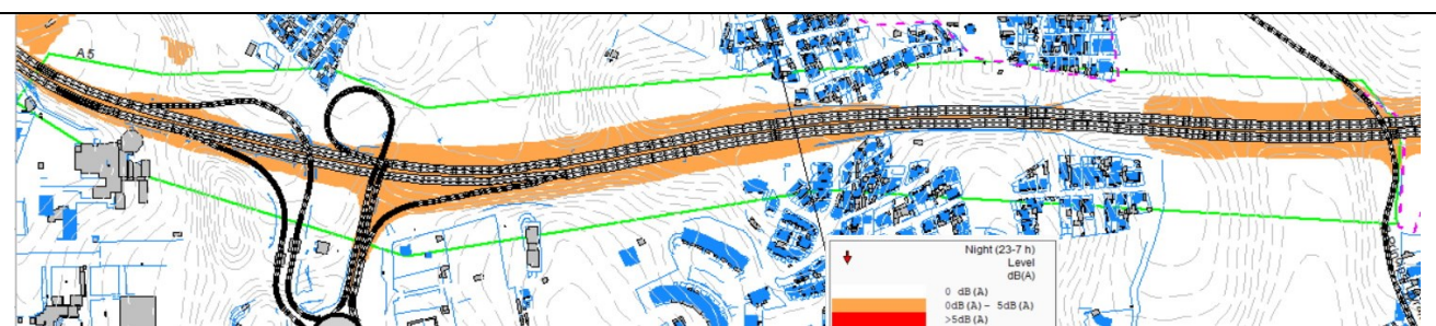
Figura 3 – Condições de fachada do Edificado – Lden
