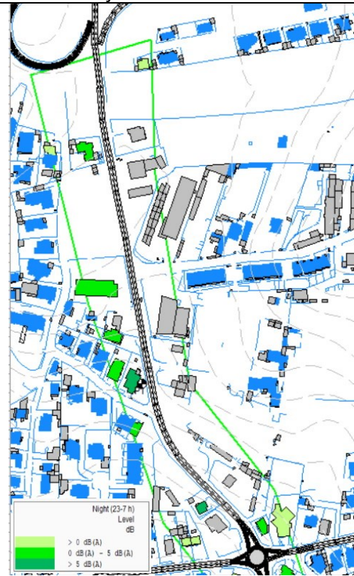
Figura 4 – Condições de fachada do Edificado - Ln
