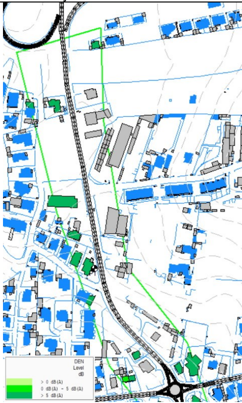
Figura 3 – Condições de fachada do Edificado - Lden
