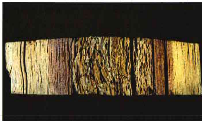
Fig. 34 -Corte do tronco de pinheiro com o cerne afectado por podridão branca.
