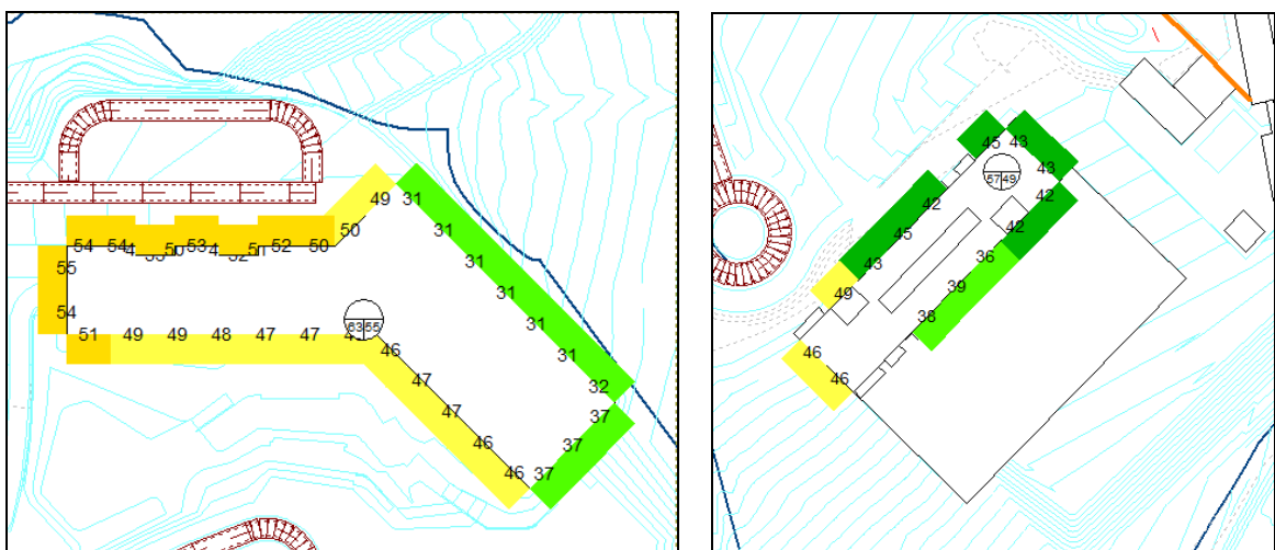
Figura 4-16 – Níveis incidentes na fachada dos principais recetores sensíveis para L_n – Rodovias apenas
