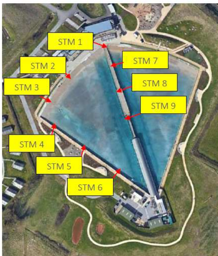
Figura 4-12 – Pontos de medição para caracterização da emissão sonora da piscina das ondas de Bristol.
