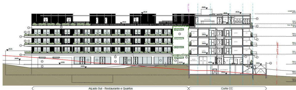
Figura 22 – Extrato de alçado a sul, com demonstração dos grandes envidraçados que potencial uma iluminação natural (hotel) CMC, 2022
