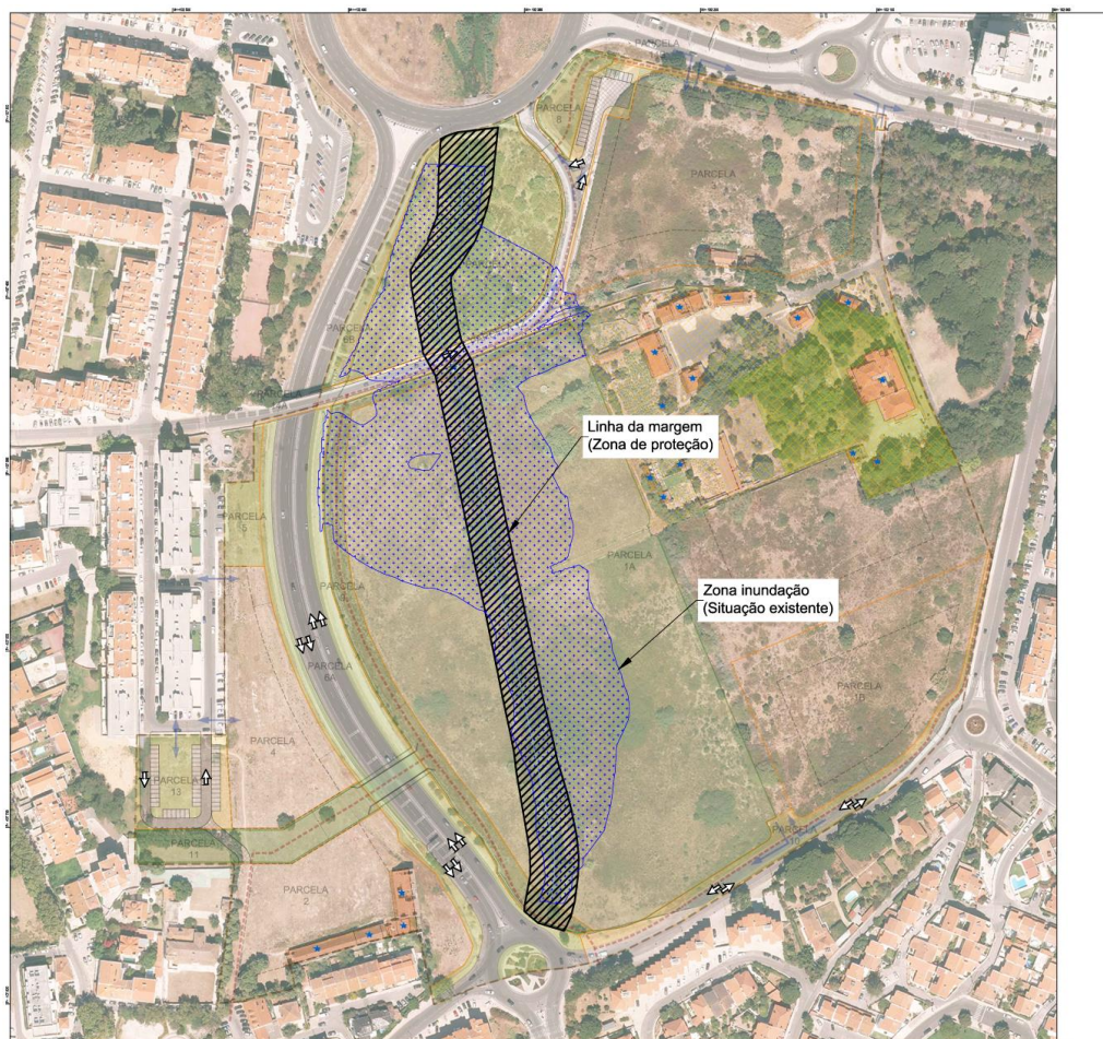
Figura 20 – Zona inundação (Situação existente) para a zona abrangida do plano Fonte: Hidrologia – Hidráulica – Zona inundação (Situação existente) (Desenho nº3)
