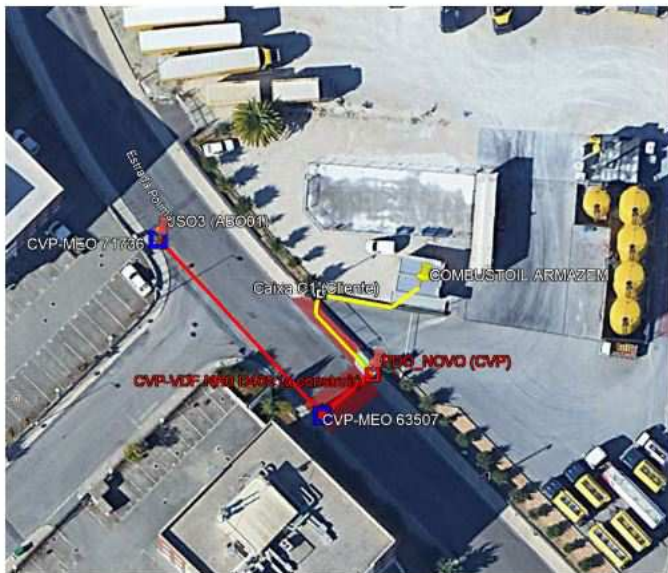
Fig.1 – Estrada Polima – Abertura de vala e passagem de cabo;
