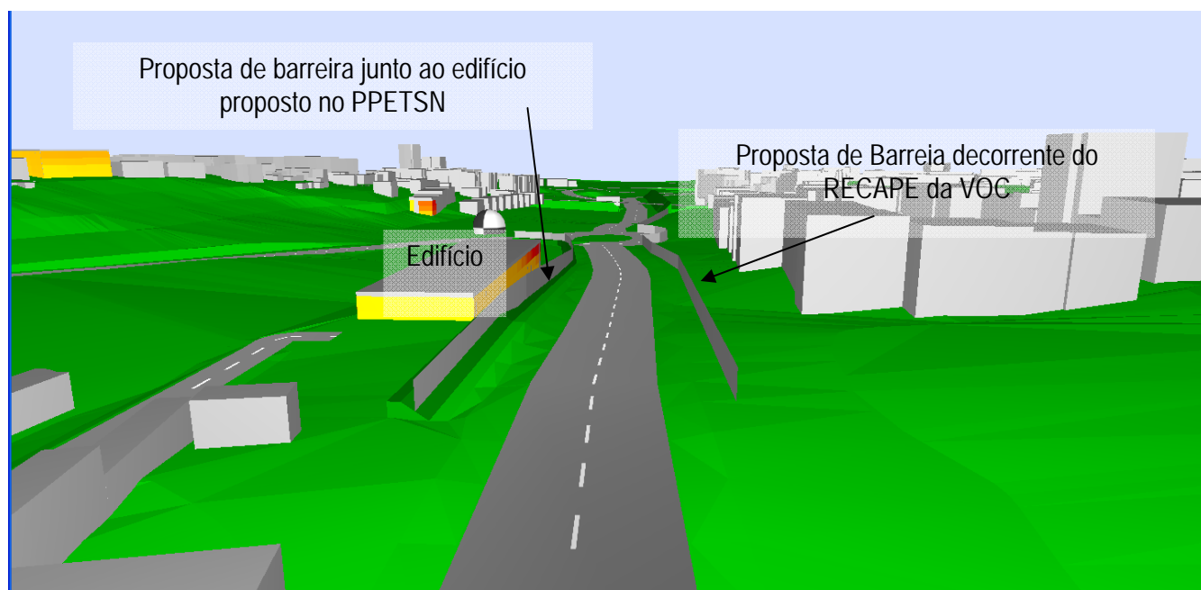
Figura 5.3.26 – Visualização da barreira acústica junto à sede do ECI
